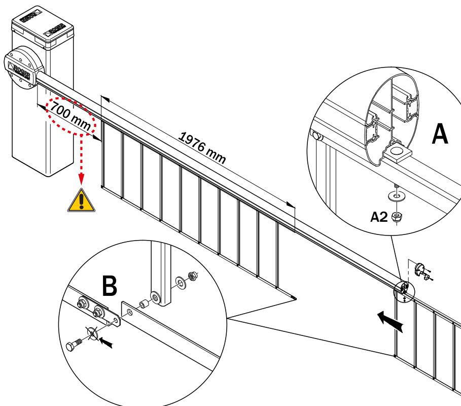
**ATTENZIONE!** Per la corretta funzionalità della barriera e chiusura della rastrelliera la quota d'installazione dove essere rispettata. **ATTENTION!** For the correct function of the barrier and the closure of the rack, the installation height must be observed.
