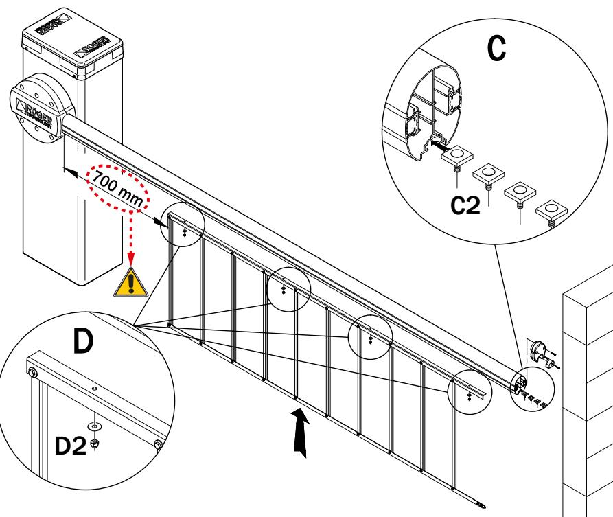
**ATTENZIONE!** Per la corretta funzionalità della barriera e chiusura della rastrelliera la quota d'installazione deve essere rispettata. **ATTENTION!** For the correct function of the barrier and the closure of the rack, the installation height must be observed.
