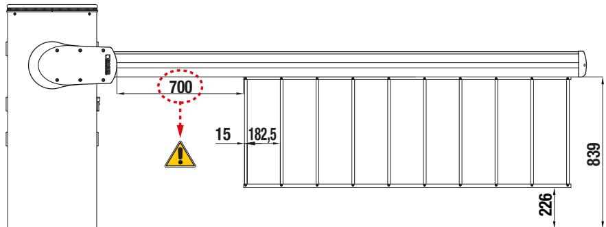
**ATTENZIONE!** Per la corretta funzionalità della barriera e chiusura della rastrelliera la quota d'installazione deve essere rispettata. **ATTENTION!** For the correct function of the barrier and the closure of the rack, the installation height must be observed.
