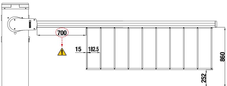
**ATTENZIONE!** Per la corretta funzionalità della barriera e chiusura della rastrelliera la quota d' installazione deve essere rispettata. **ATTENTION!** For the correct function of the barrier and the closure of the rack, the installation height must be observed.
