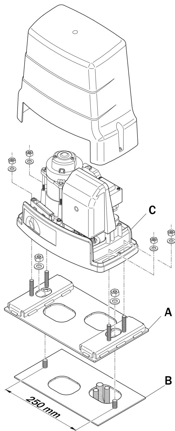
**Piastra di adattamento per automazioni scorrevoli Serie H30 e/o BH30 • Adaptation plate for sliding automations of the H30 and/or BH30 range • Passplatte für Schiebetorantriebe Baureihe H30 und/oder BH30 • Plaque d'adaptation pour automatismes coulissants Série H30 et/ou BH30 • Placa de adaptación para automatismos correderos de la Serie H30 o BH30 • Chapa de adaptação para automatismos deslizantes Série H30 e/ou BH30**
